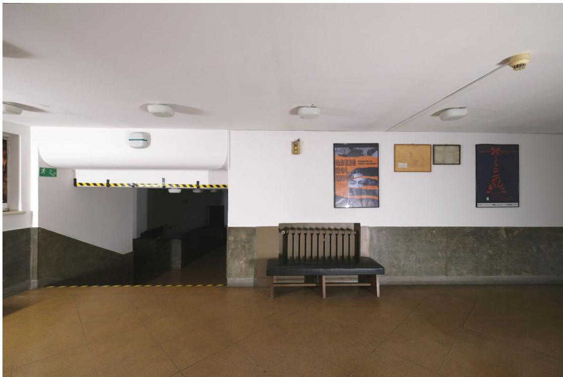
FOT. 127. TEATR POLSKI SCENA KAMERALNA, BUDYNEK GŁÓWNY TEATRU, CZĘŚĆ ZACHODNIA. SZATNIA (LOBBY) NAD FOYER, WIDOK W KIERUNKU WSCHODNIM. ZNISZCZONA CZĘŚĆ MARMORYZACJI, ZAPEWNE W ZWIĄZKU Z MONTAŻEM KALORYFERA.
